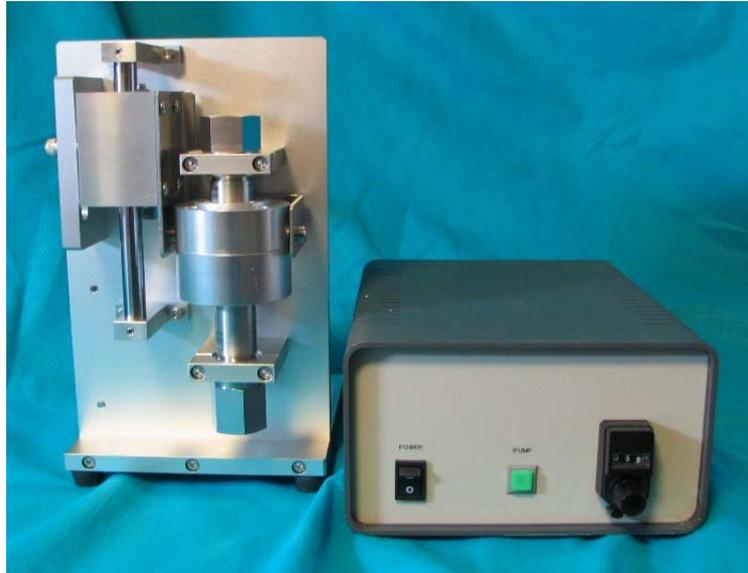
閉鎖された加圧流路中に流れを起こすために製作された特殊なポンプです。シリンダー外周に装着された強力なマグネットでシリンダー内部のチェックバルブを非接触で動作させますので、一般的なプランジャーポンプと異なり外気と接触する部分がありません。そのため圧力の損失もなく閉鎖された流路中の流体を循環させることが可能です。循環させる流体はガスでも液体でも可能です。
