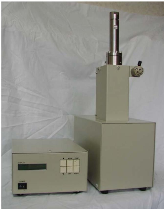
空気に触れると変質して結晶化してしまうような特殊な溶媒を送液するために製作されました。
