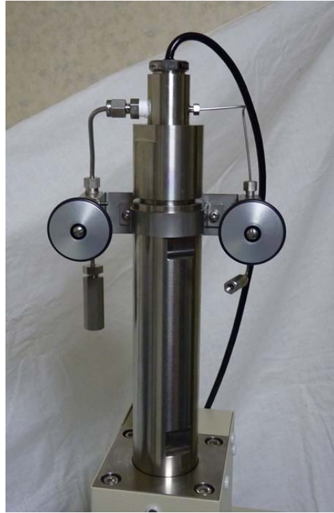
シリンダー上部（圧力センサー・手動バルブ）
