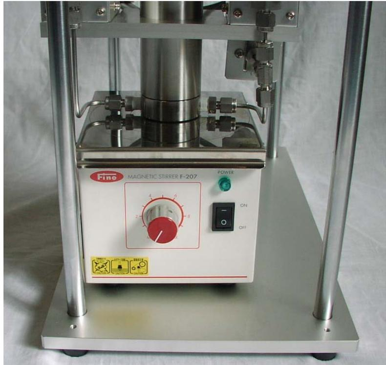
液体内部に固形物の混在するスラリー液を高圧で送液する目的で製作されたポンプです。
